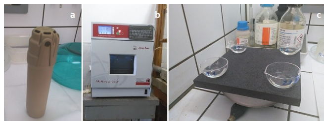
Rysunek 4. Etap mineralizacji próbek (a), odparowanie zmineralizowanych próbek i ślepych prób (b).
