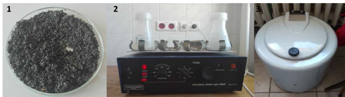
Rys.1 Przygotowanie próbki złoża do badań: 1) wysuszone złożo, 2) etap wytrząsania, 3) etap wirowania.
