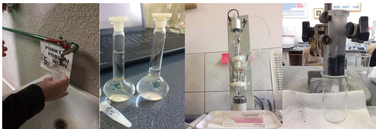
Rys.1 Przebieg eksperymentu (od lewej: pobór próbki, przygotowanie próbek do analizy, układ pomiarowy, proces filtracji).
