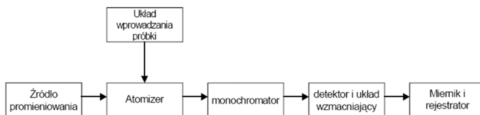
Rys.3 Schemat blokowy spektrometru absorpcji atomowej [11].
