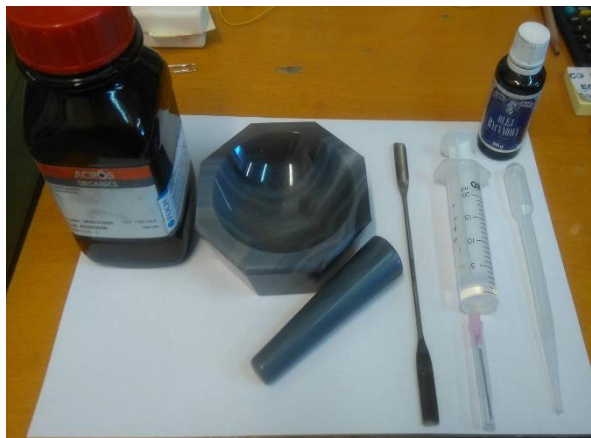
Rysunek 2. Zestaw do przygotowania mieszanki pastowej.
