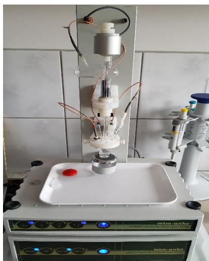
Rysunek 3. Aparatura do pomiarów woltamperometrycznych [fotografia własna].
