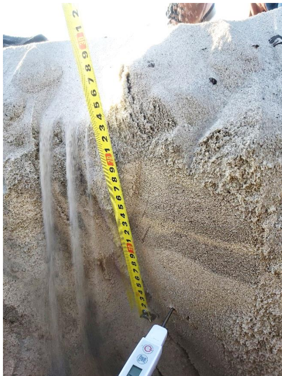
Rysunek 2. Przedstawienie sposobu wyboru miejsca pobierania próbek (profil na głębokości 30 cm od powierzchni).
