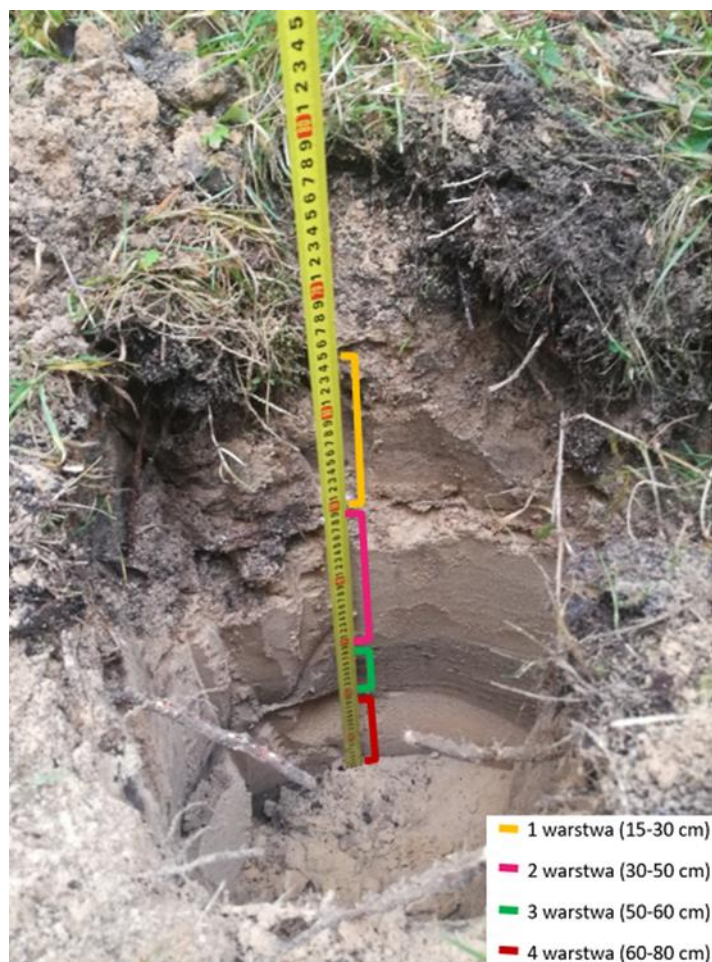
Rysunek 2. Miejsce poboru próbek z różnych głębokości z widocznymi warstwami profilu glebowego.
