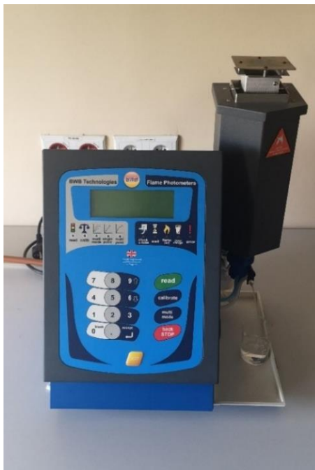
Rysunek 3. Fotometr płomieniowy firmy BWB Technologies użyty do analizy ilościowej.
