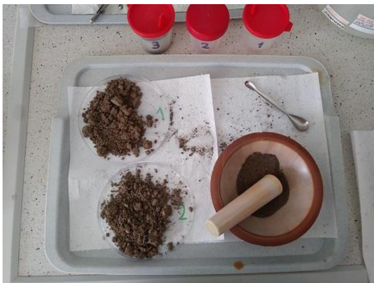
Rysunek 4. Po lewej - na szalkach Petriego - wysuszona gleba. Po prawej - w moździerzu - rozdrobniona gleba.
