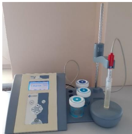
Rysunek 5. Stanowisko do pomiaru przewodnictwa elektrycznego roztworów.
