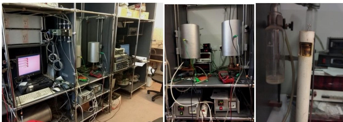
Rysunek 4. Aparatura do pomiaru przewodnictwa elektrycznego za pomocą elektrochemicznej spektroskopii impedancyjnej.
