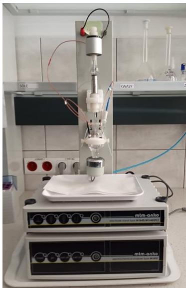
Rysunek 7. Aparatura do pomiarów woltamperometrycznych (analizator elektrochemiczny M161E MTM-Anko Kraków).
