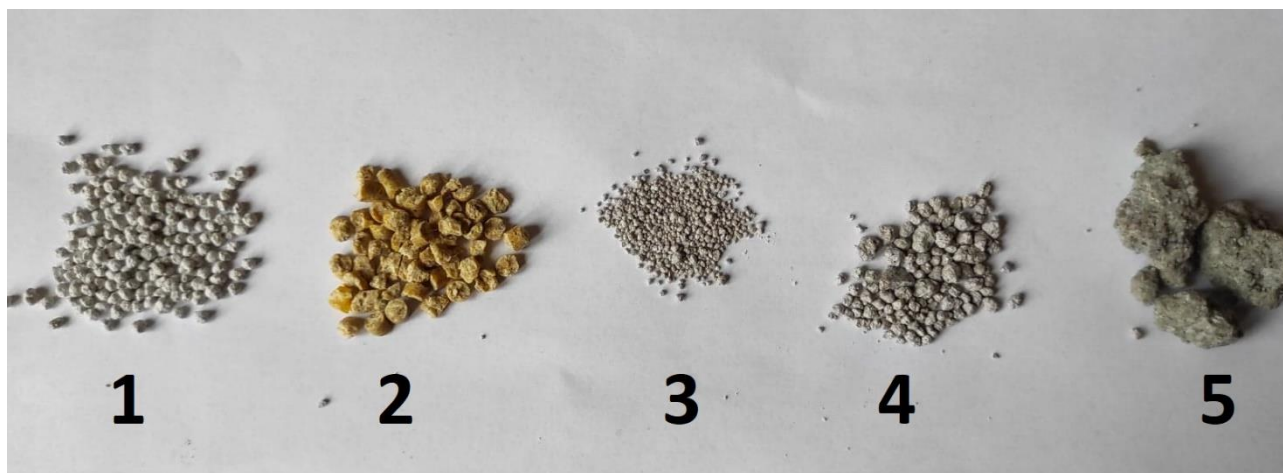
Rysunek 1. Próbkki wykorzystane do badania rozkładu wielkości cząstek, kolejno: 1. Żwirek „Shaggy” 2. Żwirek kukurydziany 3. Żwirek zapachowy 4. Granulat – forma przejściowa 5. Bentonit - surowiec wejściowy, baza do produkcji żwirku [źródło: zdjęcie własne].
