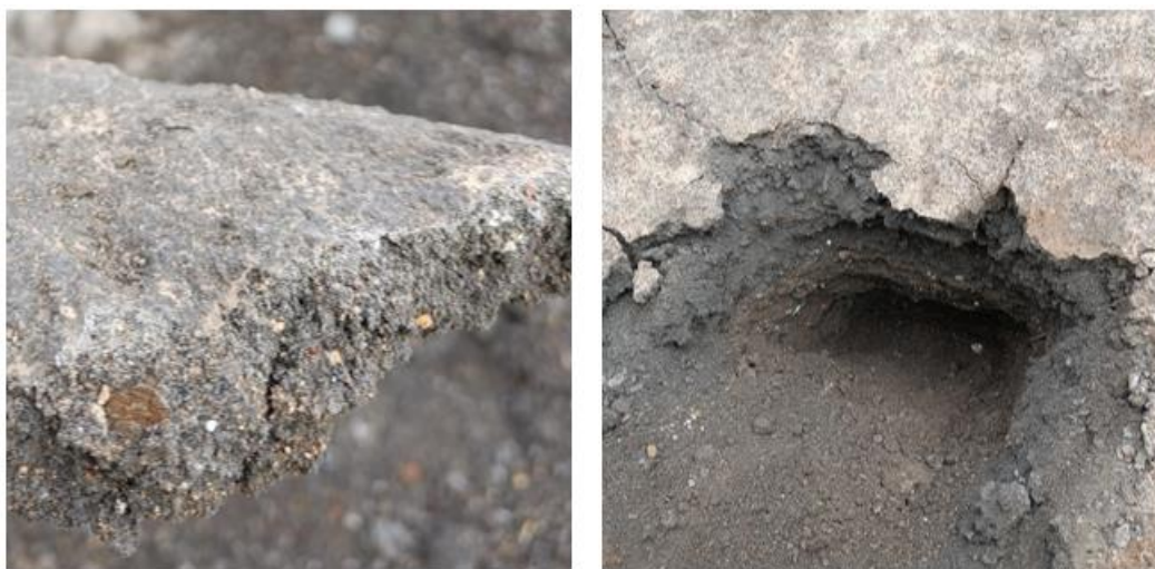
Rysunek 1. Pobrany materiał do badań (od lewej: warstwa wierzchnia hałdy, warstwa głęboka hałdy).
