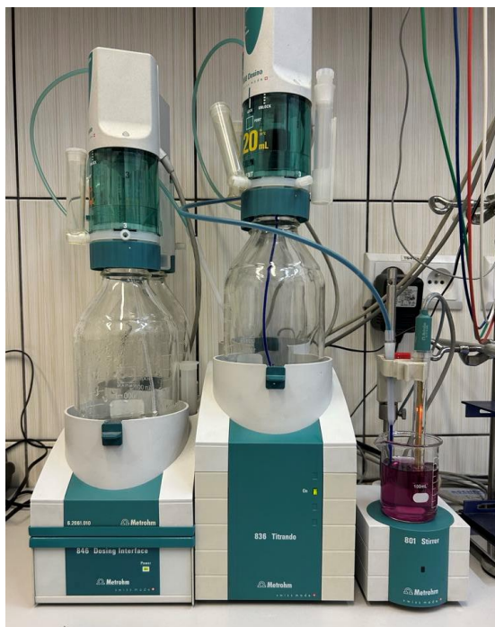
Rysunek 2. Urządzenie pomiarowe do spektrofotometrycznego miareczkowania z zastosowaniem odczynnika DCPIP.
